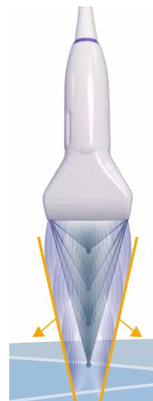
Obrázek 9: Generování pomocí SonicTouch™. Příčné vlny jsou zesíleny ve tvaru "Machova kuželu" (žlutě), což zvyšuje vzdálenost šíření příčných vln při minimalizaci akustického výkonu.
